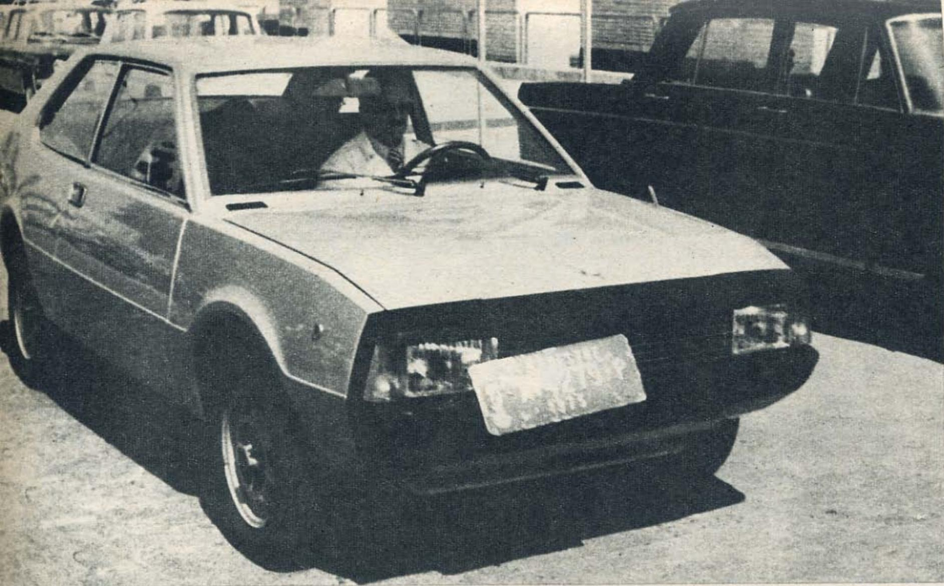
El frontal negro formado por una —o quizá dos— pieza de poliuretano, sustituye al clásico parachoques metálico. Un tímido proyecto de faldón «spoiler» se adhiere en la zona frontal inferior.
