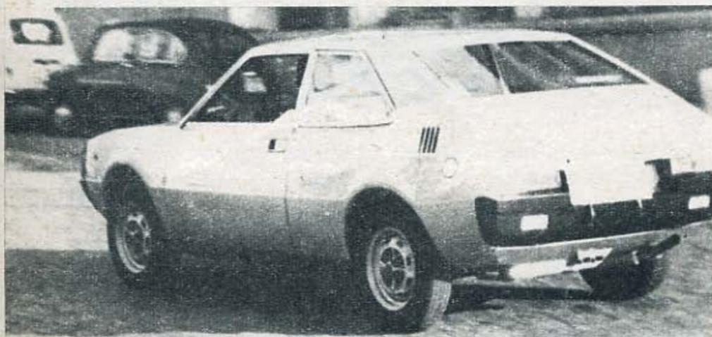
En el parachoques posterior de plástico van alojados los elementos ópticos reflectante; los pilotos e intermitentes van situados más arriba. El tapón de gasolina, aunque a la vista, parece quedar totalmente encastrado en la carrocería, sin sobresalir como en el 127.
