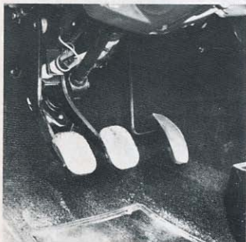
El accionamiento del pedal de embrague sería más cómodo si en lugar de estar colgado pivotara sobre un eje inferior.
