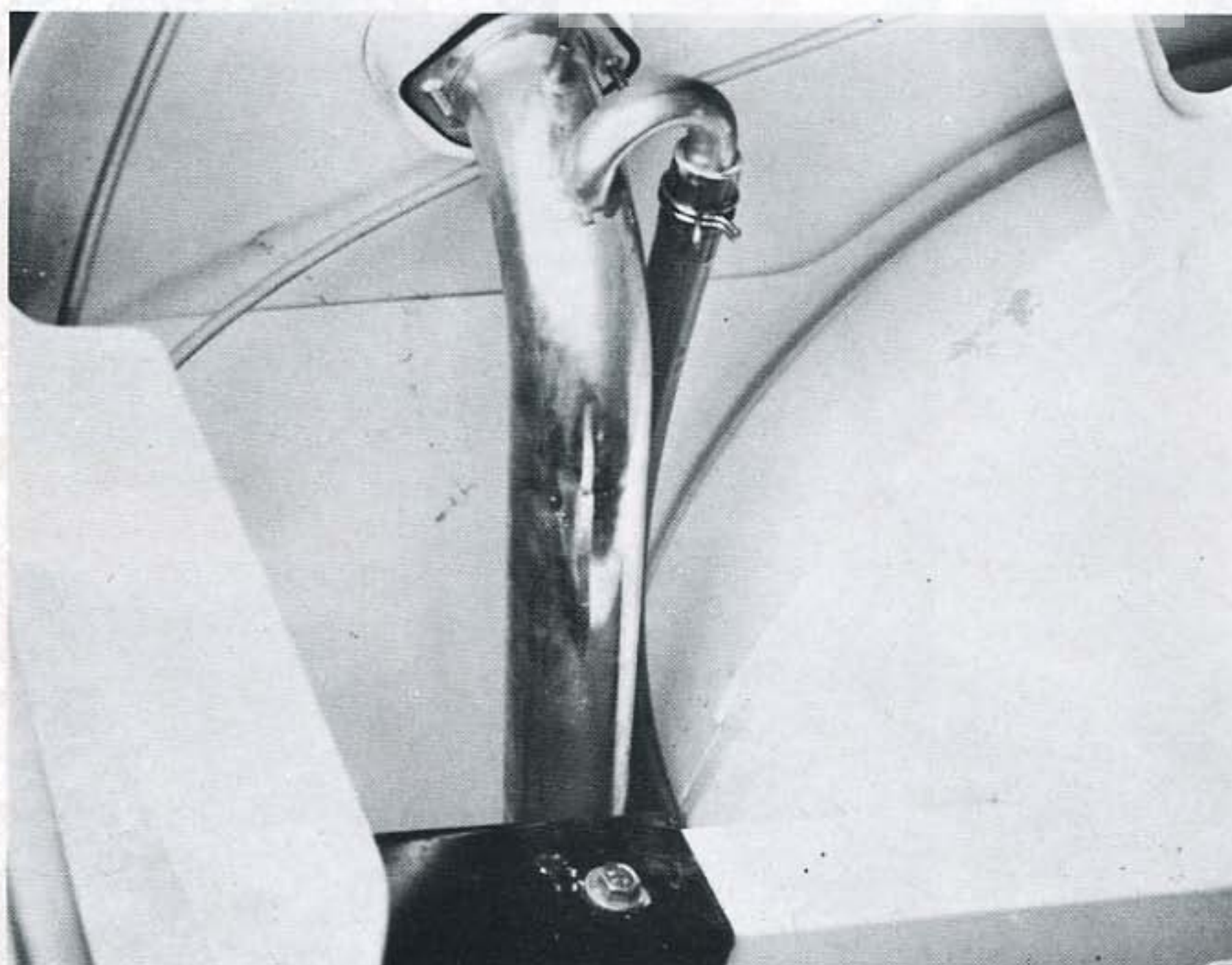
En el pasarruedas izquierdo se dispone la entrada de gasolina al depósito, que se encuentra debajo del cofre.
