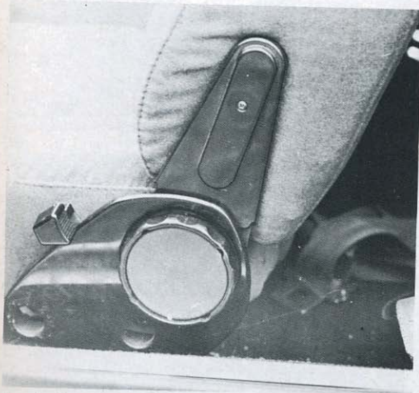
Para abatir el respaldo de los asientos delanteros se dispone de este mecanismo en la parte lateral.
