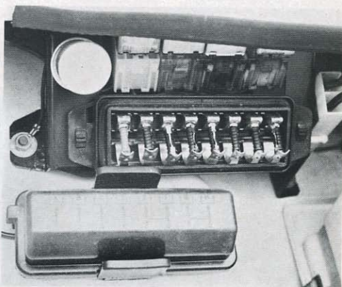
La caja portafusibles y los relés van en el compartimento motor, en su parte derecha.
