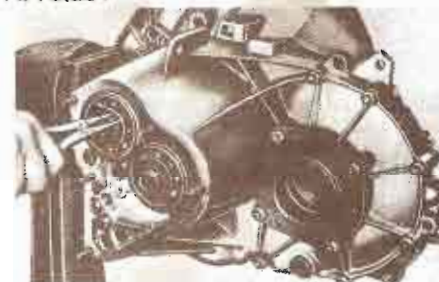
Montaje del anillo de seguridad del árbol primario mediante alicates de puntas
