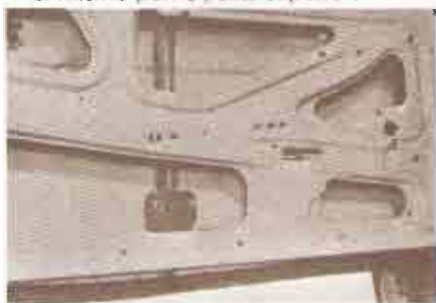
Fijación del cristal descendente al soporte de arrastre
