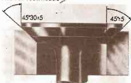
Valor de los ángulos de asiento y cabeza de válvula
