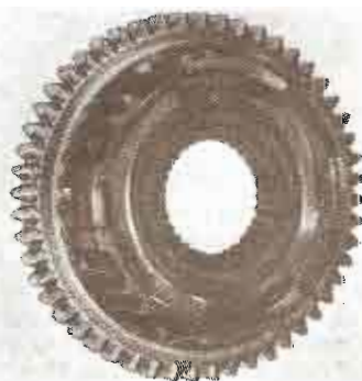
Engranaje de 1ª velocidad y mecanismo de sincronización
