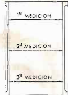
Esquema para la medición de los cilindros
