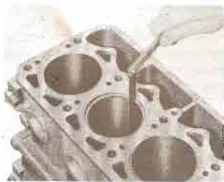
Control del juego entre las extremidades de los segmentos una vez alojados en sus cilindros
