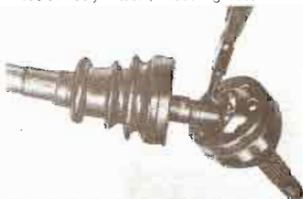
Separación junta homocinética del semiárbol mediante la extracción del anillo elástico con el útil A. 81.124
