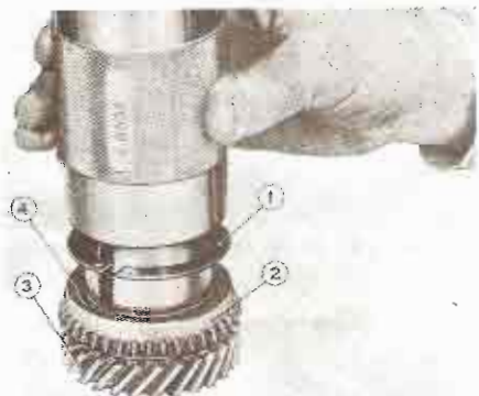
Montaje del anillo elástico del sincronizador de la 3ª y 4ª velocidad mediante el útil A. 8.602
