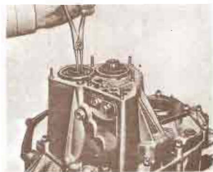
Separación del anillo elástico retención rodamiento árbol primario sirviéndose de unos alicates de puntas
