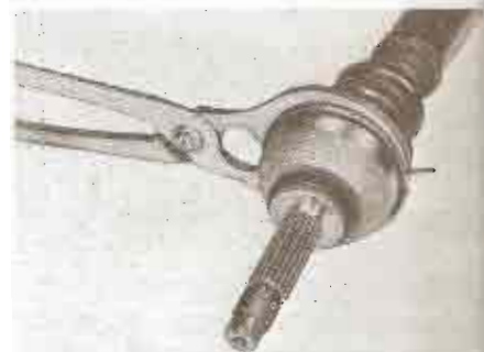
Montaje abrazaderas retención guardapolvos con auxilio del útil A. 81.118
